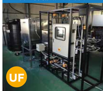
安定した脱色による省人化 (高濃度時の薬剤調整による脱色性確認不要)
