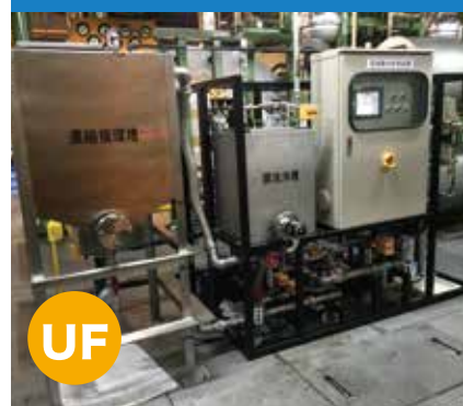
総合排水処理設備の負荷低減 (前処理によるクーラント成分除去)
