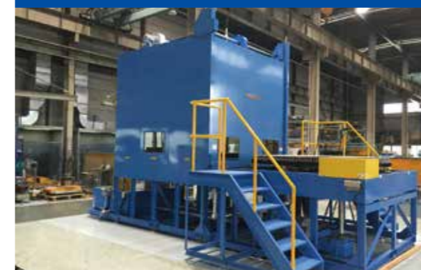
人的洗浄工程からの脱却による省人化 (高圧洗浄ガンによる手作業の自動化)
